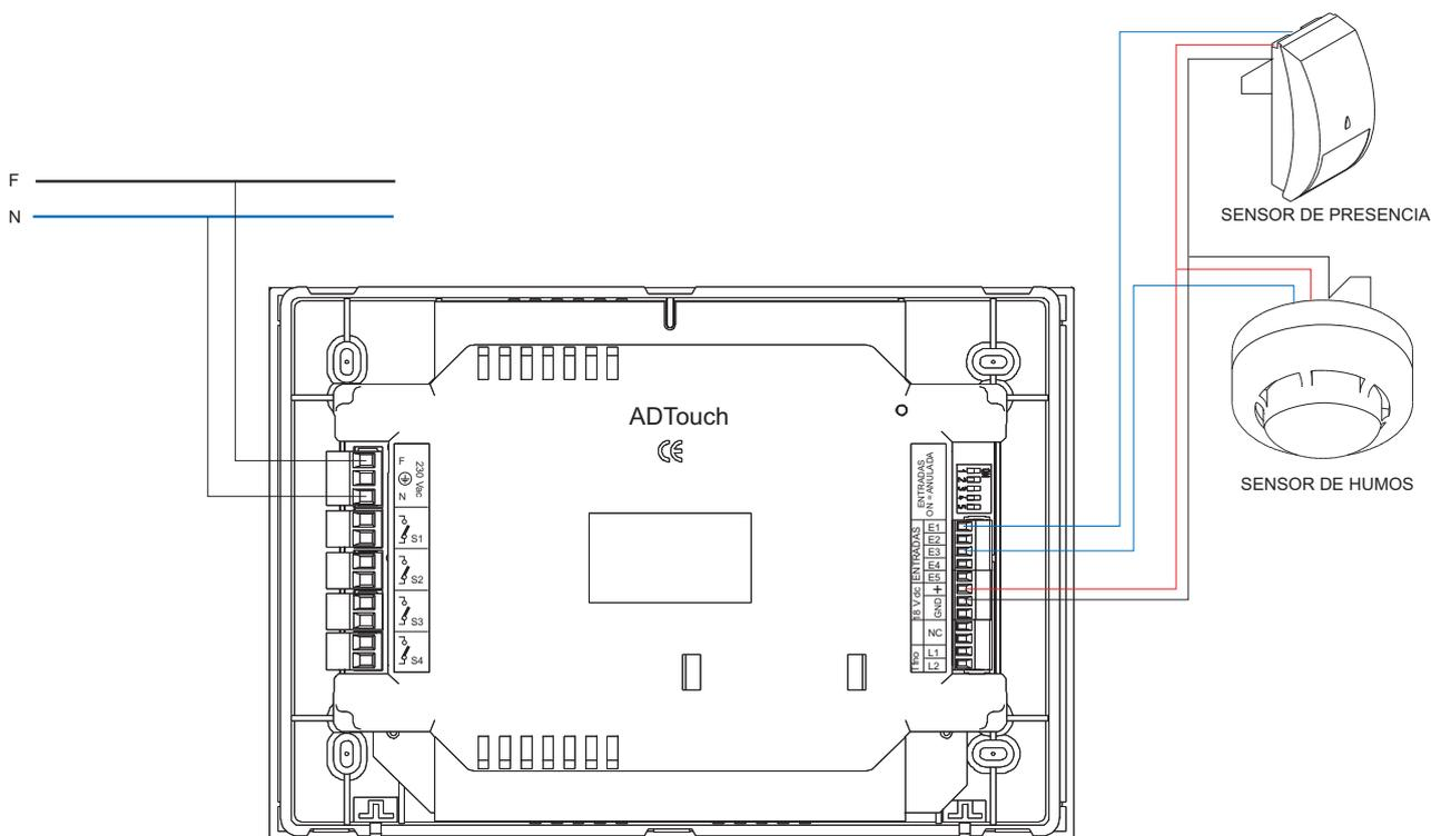
Esquema de instalación con sensores externos opcionales
